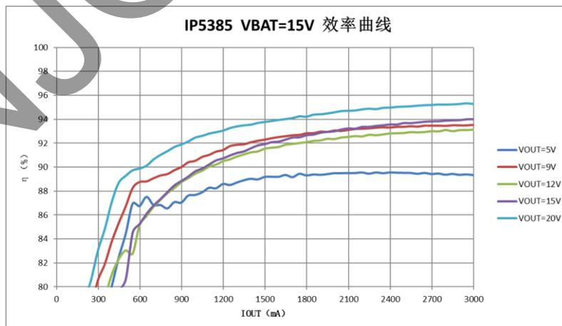
图 4 4 串 65W 放电效率曲线图
